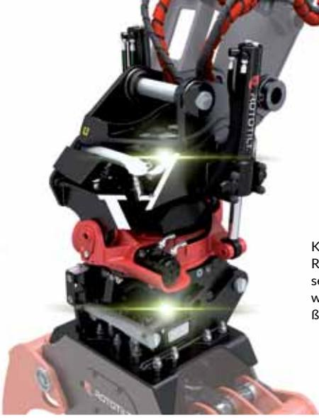
Konsequente Sicherheit: Rototilt stattet ab sofort alle selbst produzierten Schnellwechsler ab Werk serienmäßig mit SecureLock aus.
