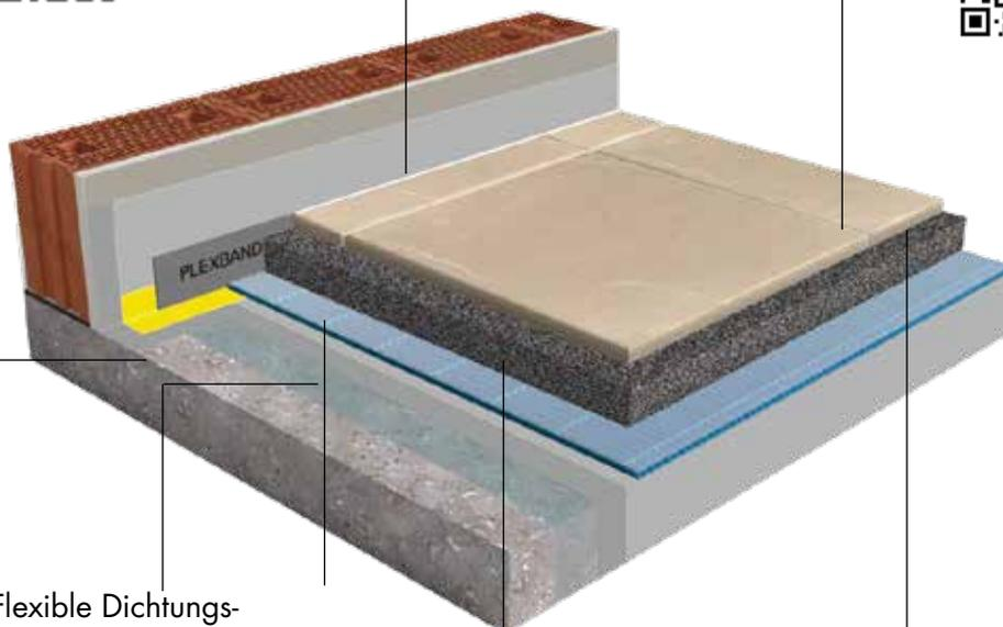
Flexible Dichtungsschlämme FDS
