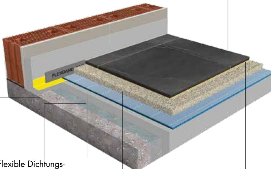
Flexible Dichtungsschlämme FDS
