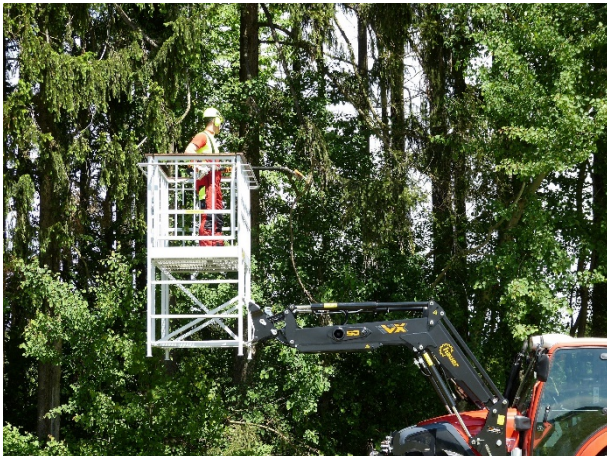
Sicheres Trägerfahrzeug mit sicherem Arbeitskorb. In jedem Dorf, in jeder Gemeinde soll so eine Kombination zum sicheren Arbeiten in der Höhe vorhanden und für alle verfügbar sein.
