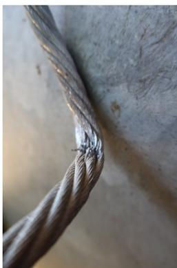
Sind an einem Stahlseil Litzen gebrochen, bedeutet dies Ablegereife. Der Unternehmer muss das Seil der Weiterverwendung wirksam entziehen, heißt verschrotten.
